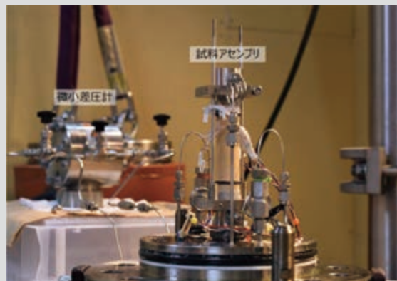
図1 三軸圧縮試験装置圧力容器内に設置する試料アセンブリ(手前)及び微小差圧計(奥)
