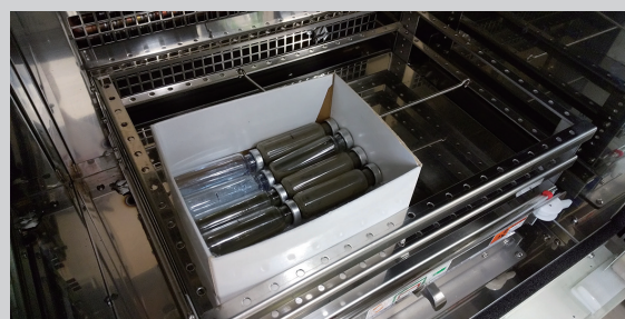
図2 吸着試験の様子 (実際には上部も固定して振とう培養します)
