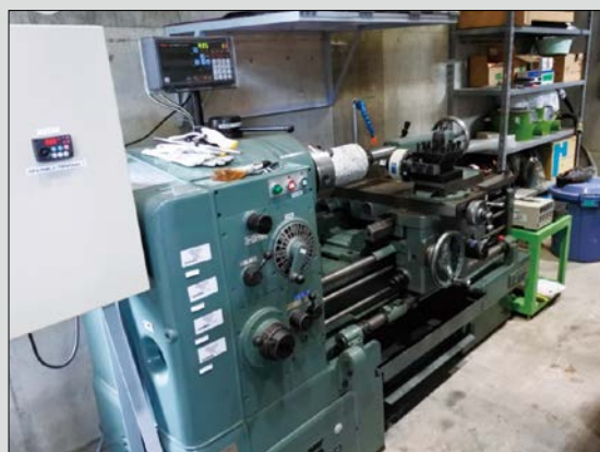
岩石の回転切削試験装置
