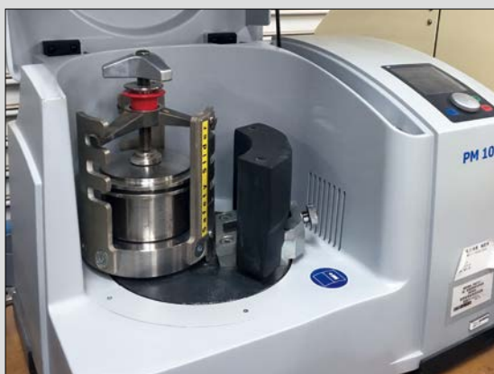
銅鉱石の粉砕試験に用いた遊星ボールミル。公転と自転を組み合わせた遠心力によってラボスケールであっても、強力な粉砕が可能な装置である。
