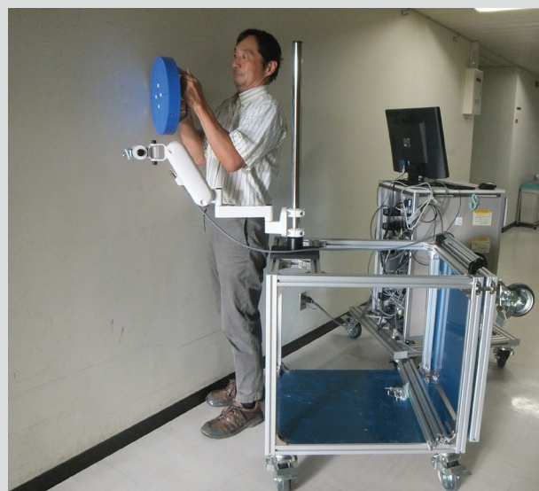
図2 製作中の磁気共鳴表面スキャナー。手に持っているのは希土類永久磁石（青いカバー付）、前景は磁石キャリア、背景は分光器本体。磁石は、磁石キャリアのアームに取り付ける予定。
