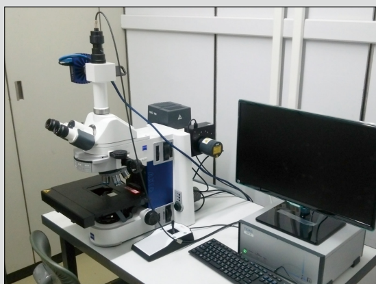
石炭の組織観察に用いた反射顕微鏡システム。白色光での観察の他、紫外光によって有機物の励起状態を観察することも可能である。
