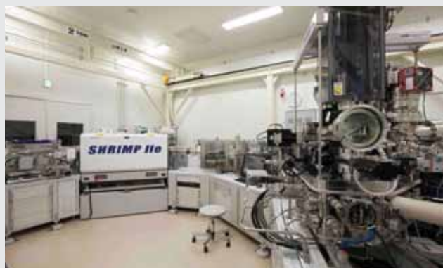
図 1 二次イオン質量分析計 SHRIMP IIe（写真撮影：安友康博）
