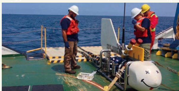
深海曳航式の海洋電磁探査
