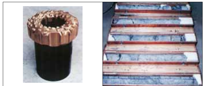
開発したPDCコアビット(外径215mm)と回収コア
