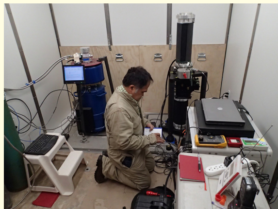
写真 2：超伝導重力計と絶対重力計による並行観測
