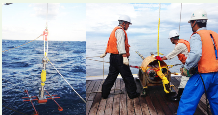
図3. 海底水温モニタリング装置（左）と、地殻熱流量測定装置（右）。
