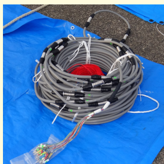
写真1 本研究で導入した海中測定用多芯電極ケーブル
