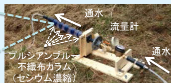
ブルシアンブルー担持不織布 (左) とモニタリングシステム (右)
