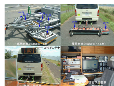
地盤緩み域調査のための車載型地中レーダ探査の様子。
