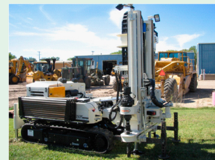
図2 液状化調査などに用いられるコーン貫入試験装置
