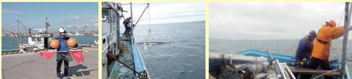
写真 1 開発中の浅海用電磁探査法システムの調査風景（北海道幌延町沿岸域にて）。 左：測定器海底投下作業の出航前に、装置の目印となる浮きと旗を確認している筆者。 中：調査船船尾からの測定器海底投入作業（測定器が着水した状態）。 右：海底で 3 日間の電磁場測定を終えた装置の回収作業（1 台目を回収し 2 台目を引き上げているところ）。
