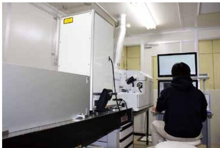
写真2 鉍物資源研究グループ所有のレーザーアブレイションICP-MS
