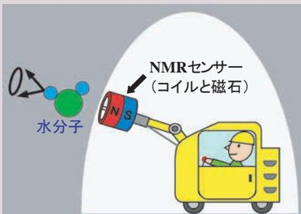
図1 トンネル壁のNMRスキャン作業風景のイメージ
