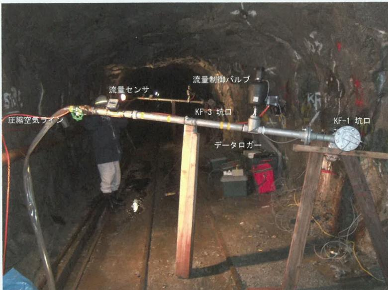
図1 釜石鉱山KF-1坑における坑内自然電位変化測定の実験風景（2006年）
