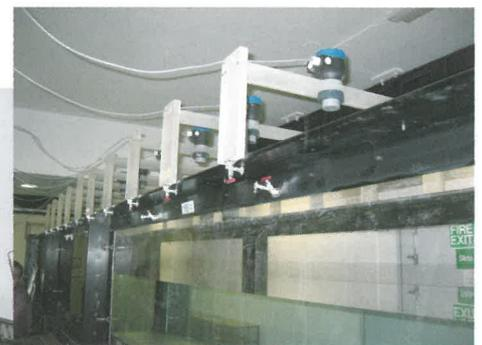
写真3 リーズ大学Sorby laboratoryの重力流実験用大実験水槽
