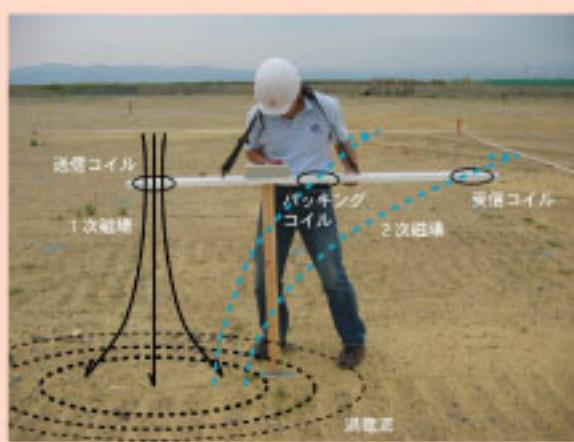
図3 電磁プロファイリング法のデータ取得風景。
