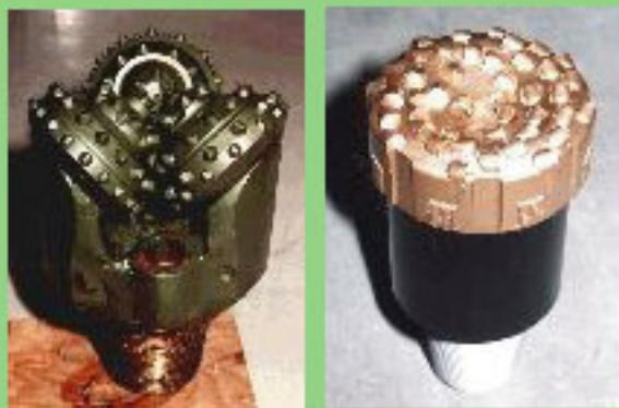
図2 ローラコーンビット（左）とPDCビット（右）
