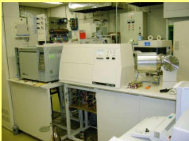
写真2 ガスクロマトグラフ燃焼同位体質量分析計。バイオマーカーの炭素同位体比を測定できる。
