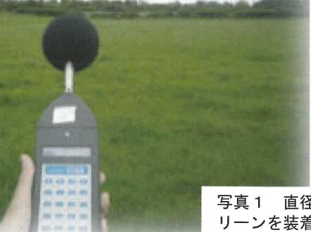
写真1 直径9cmウンドスクリーンを装着した屋外騒音計測
