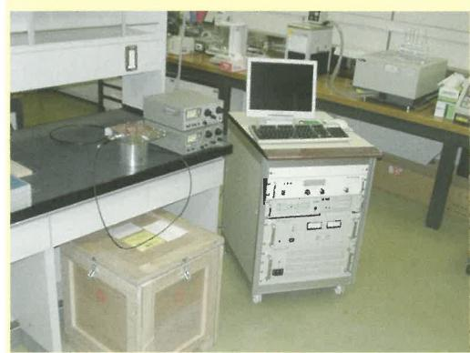
写真2 現在製作中のポータブルNMR装置。コンクリートや岩盤中の含水亀裂の検知など、土木分野への応用を目的としている。
