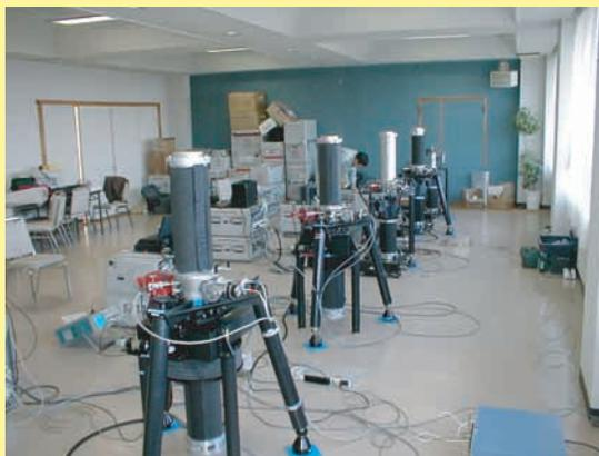
写真2 絶対重力計の相互比較。各研究機関の絶対重力計を同じ場所に集め、同時に重力を測定して精度の確認と情報交換を行う。
