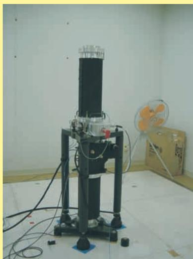
写真1 絶対重力計。筒の中を自由落下する物体の距離と時間から重力を求めます。
