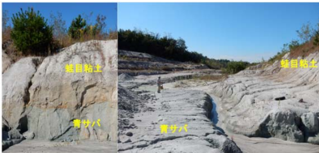
青サバは、蛙目粘土（良質な陶磁器原料）の下位に広く分布し、カオリン分に富むが、不純物（毒母類）が多く、これまで採掘・利用されなかった（写真：瀬戸市晚鉱山）。
