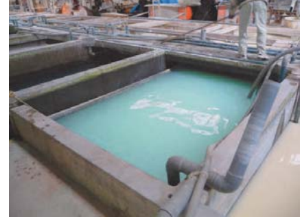
沈殿槽で重力沈降 (凝集沈殿)
