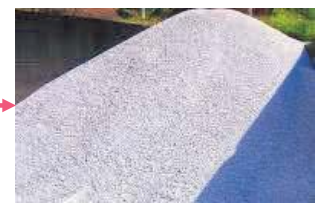
脱鉄陶石製品として出荷 ( \text{Fe}_2\text{O}_3 :0.4%以下)
