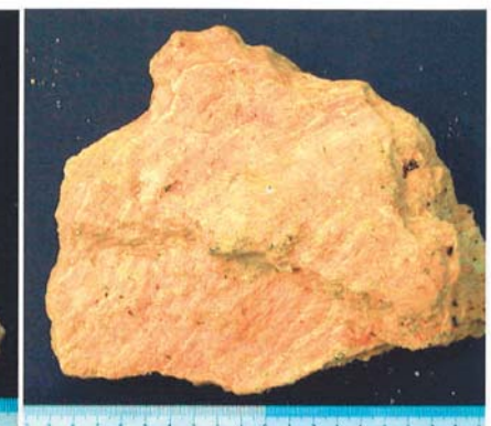
陶石化部分(縞石) 1~2mm幅の縞で構成されている。(下部鉞体)
