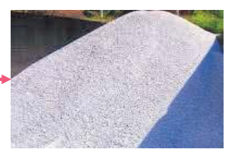
脱鉄陶石製品として出荷 ( \text{Fe}_2\text{O}_3 :0.4%以下)
