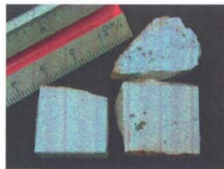
C陶石 切断面 自形の黄鉄鉱を認める
