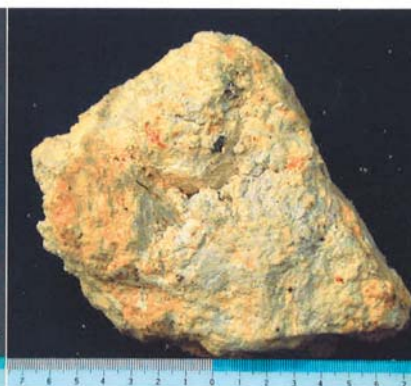
陶石化部分 流理構造が微かに残っている。(上部鉞体)
