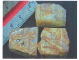
石英脈 切断面 角れき化した陶石を膠結(下左)
