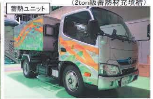
トラック搭載時の蓄熱システム (2ton級蓄熱材充填槽)
