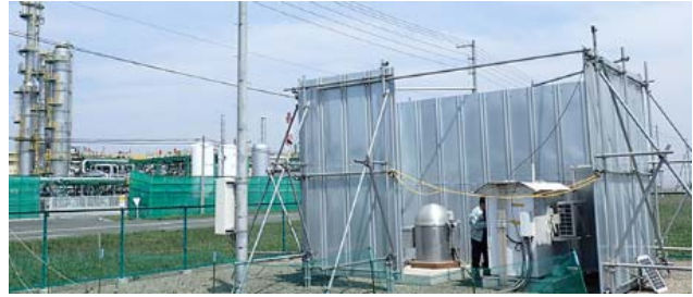
苫小牧実証試験サイトにおける超伝導重力計による連続計測。
