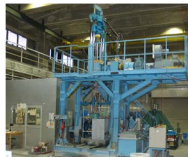
掘削試験装置。
