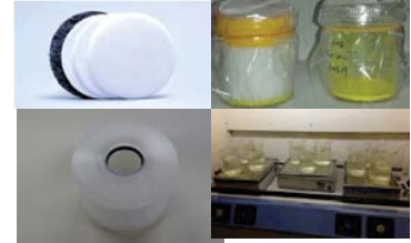
図1 精度評価試験で使用した濃縮技術 (左上：固相ディスク抽出法 (3M社提供)、右上：AMP法 (放医研 青野氏提供)、左下：PBフィルターカートリッジ法、右下：蒸発濃縮法 (東北農研 申氏提供))
