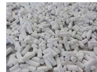
図1 ハスクレイ前駆体による造粒体 直径2mm長さ数mmの造粒体を開発
