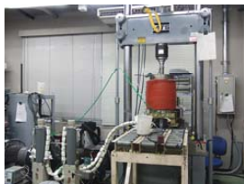
三軸岩石透水(気)実験システム 差圧下、岩石の浸透率・ひずみ・弾性波速度等を同時に測定
