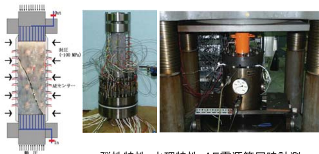
弾性特性・水理特性・AE震源等同時計測
