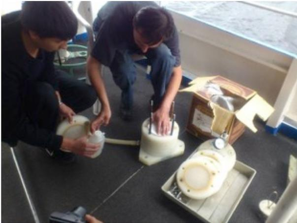
写真 4-5-1 多段型フィルター 組立作業
