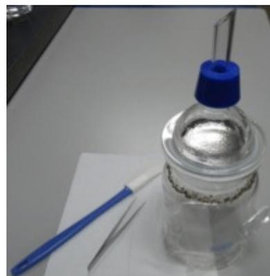
写真 4-2-5-3-2 ろ過装置から取り外したフィルターホルダー
