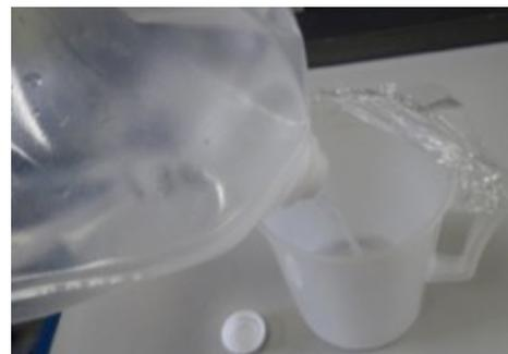
写真 4-2-5-3-3 水容器内に超純水を入れて良くすすぎ、超音波洗浄機にかける。必要に応じて、水容器を切り開き、内壁の付着物をヘラで良くこすり取る。これらをピッチャーに入れる。
