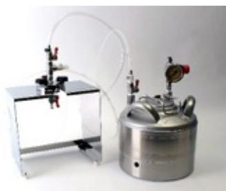
写真 3-5-3-1 加圧通水装置
