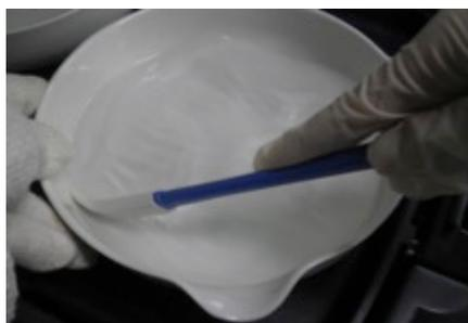
写真3-2-2-4 内壁を試料液で濡らしながらヘラで良くこすり、付着物を試料液中に入れる
