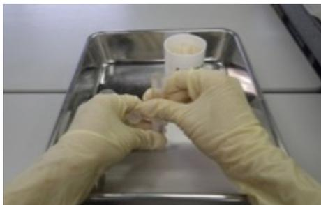
写真 3-2-2-2-10 プラスチック棒で押しながら、乾固物をサンプルチューブに均質に詰める
