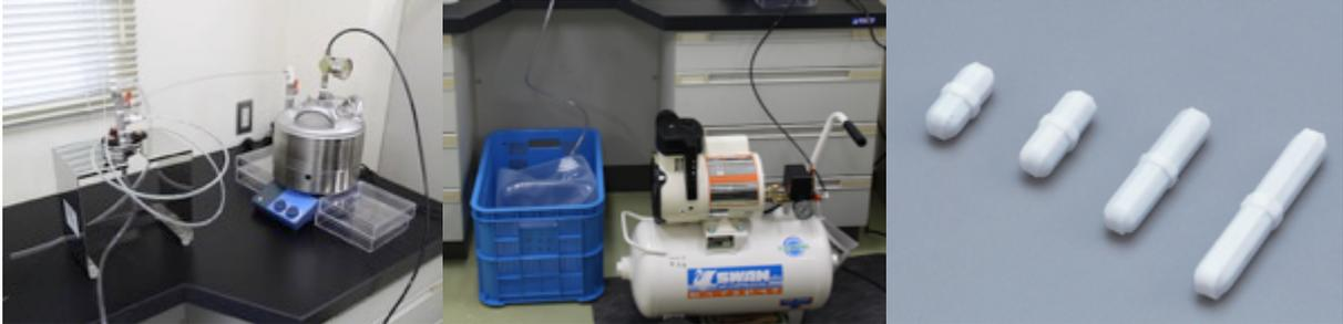
写真 4-2-2-2 加圧式ろ過器, コンプレッサー、回転子など
