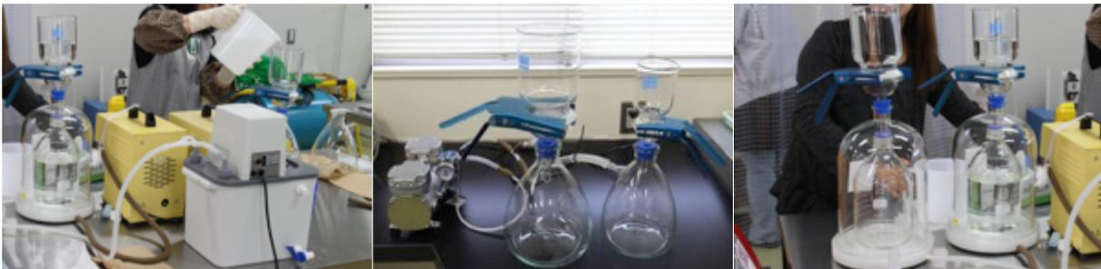
写真 4-2-2-3 減圧式ろ過器、ろ過鐘、ろ過瓶、吸引ポンプ、真空ポンプなど
