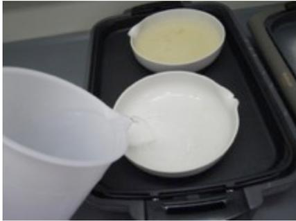
写真3-2-2-2-6 空になった蒸発皿に超純水を入れて加熱し、洗浄ビンの超純水とヘラで内壁を十分に良くこすり、付着物等の取り残しができるだけ無いようにする
