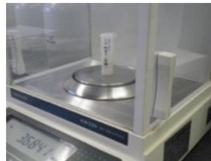
写真 3-2-2-2-11 サンプルチューブ内の乾固物の重さと充填高さを測定する
