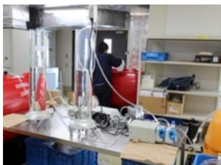
写真 5-3-2-8  $\phi$  142 mm のろ過器
