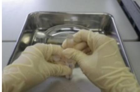
写真 4-2-5-3-9 乾燥した懸濁物をサンプルチューブ内に均質に詰める。プラスチック棒を利用して、強く押し込みながら、少しずつ充填する。ステンレスバット上で作業を行い、こぼれた懸濁物も丁寧に回収してサンプルチューブ内に詰める。
