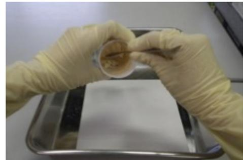
写真3-2-2-2-9 ステンレスバットの中に薬包紙を敷き、テフロンビーカー内の乾固物を掻き出す
