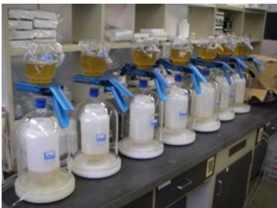
写真 4-2-5-3-1 7台のろ過装置によるろ過実施状況
