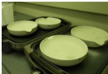
写真3-2-2-3 ドラフトチャンバー内のホットプレート上で蒸発濃縮する
