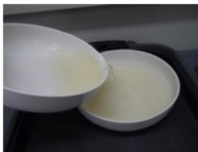
写真3-2-2-5 試料液量が少なくなったら、一つの蒸発皿に試料液を集める
