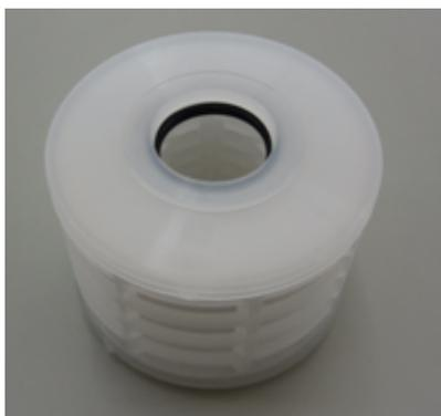
写真 3-6-1-1 亜鉛置換体プルシアンブルー担持不織布カートリッジ
