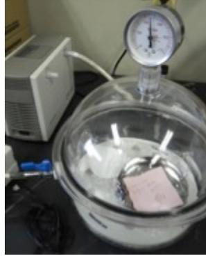
写真 4-2-5-3-8 蒸発濃縮した液をステンレス皿上の懸濁物に添加する。2 回目のろ過のろ紙とステンレス皿に軽くラップをして、減圧デシケーター内で一晩以上、乾燥させる。
