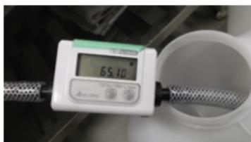
⑤通水速度が2.0L/分以下となるよう、ポンプの回転数を調整する。
