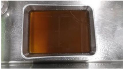
①濃縮に使用する陽イオン交換樹脂をバット等にあけ、純水でよく洗浄する。
