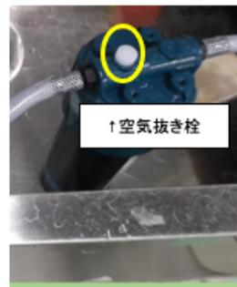
④用いる機材を正しく接続し、通水を開始する。ハウジング上部の空気抜き栓で内部の空気をよく抜いておく。
