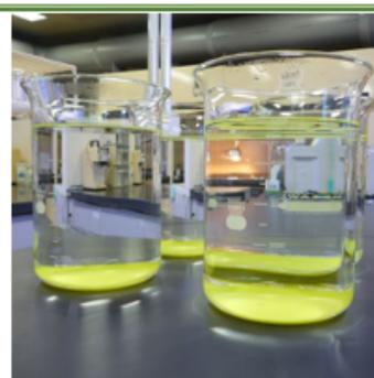
② AMPを沈殿させるため静置
