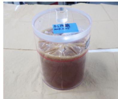
⑧かき混ぜた後の陽イオン交換樹脂を700mLマリネリ容器に封入し、ゲルマニウム半導体検出器による測定に供す。
