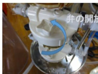
④ハウジングの空気弁を開放し、弁から水が出たら閉める
