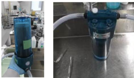
③陽イオン交換樹脂入りの1インチカートリッジをハウジング内にセットする。この後、純水10L程度を通水してコンディショニングを行うとよい。
