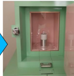
専用容器にカートリッジを入れて、直接測定
