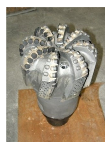
室内掘削試験で使用したPDCビット
