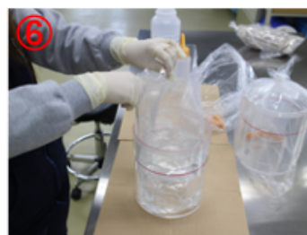
⑥ ガラス棒を用いて 隙間の空気を減らす
