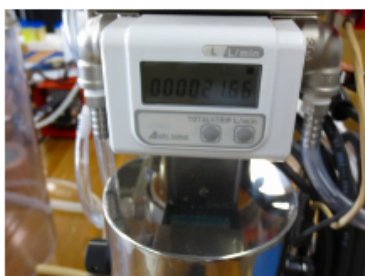
⑦ 通水前後の容器重量の差、または流量計による通過流体量から通水量を算定する。
