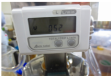
⑤ 流量計の読みを見ながらつまみを調整し流量を調整
