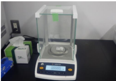
⑧乾燥後のメンブレンフィルターを秤量する
