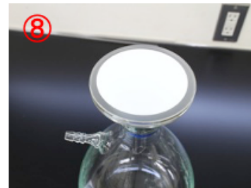
⑧ ピンセットでフィルターを取り出す
