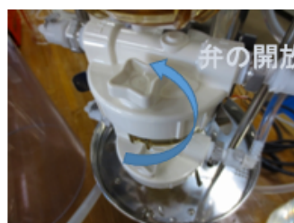
④ハウジングの空気弁を開放し、弁から水が出たら閉める
