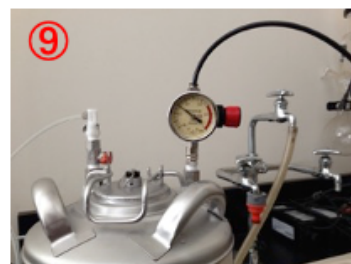
⑨設定圧力に調整する
