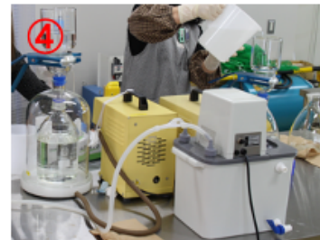
④ 試料をろ過器の上段に入れる
