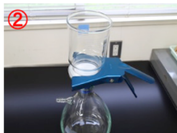
② フィルターを装着し固定する
