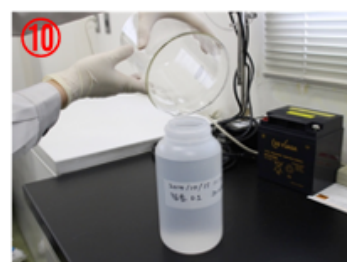
⑩ ポリ容器に移して冷蔵保管する
