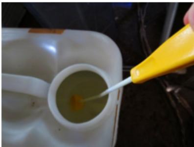
④ タンクの水を攪拌し、懸濁物質が容器底に溜まらないように注意する。
