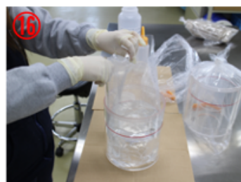
⑯ ガラス棒を用いて隙間の空気を減らす
