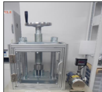
⑩裁断後のフィルターをプレス成型し、U8容器に封入する。
