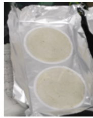
⑥メンブレンフィルターを取り外し、アルミホイルの台紙上で3日間以上風乾する。
