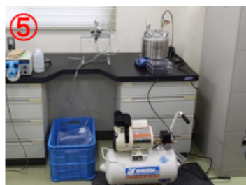
⑤コンプレッサーと加圧タンクを接続する
