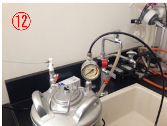
⑫ 圧力を下げ、すべてのバルブを閉じる
