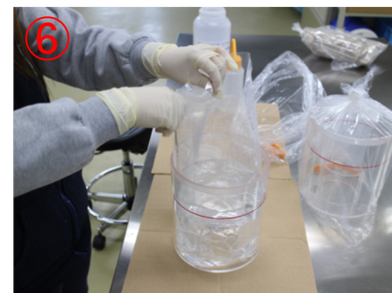
⑥ ガラス棒を用いて隙間の空気を減らす
