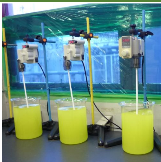
① 試料(左)に酸とAMPを添加して攪拌(右)
