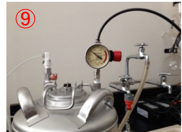
⑨ 設定圧力に調整する
