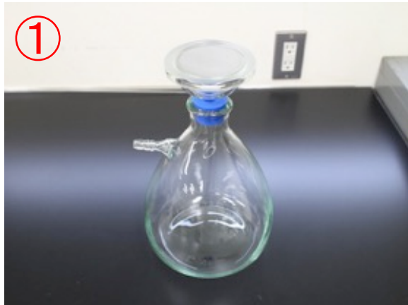
① ロートをろ過瓶に装着する
