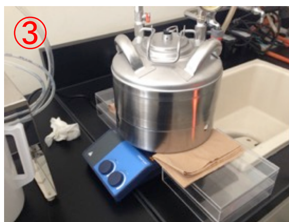
③加圧タンクを スターラーに乗せる
