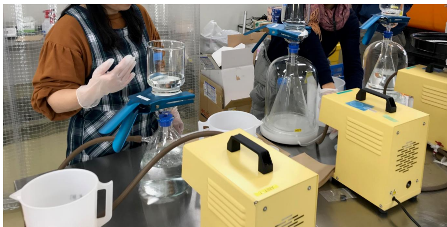
② 孔径0.45 \mu mのフィルターでろ過
