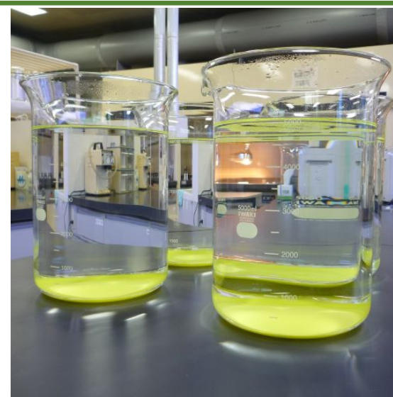
② AMPを沈殿させるため静置
