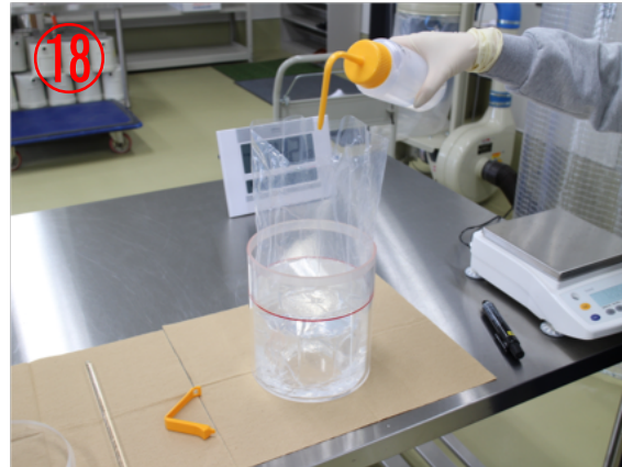
⑱ 蒸留水で2L線まで調整する
