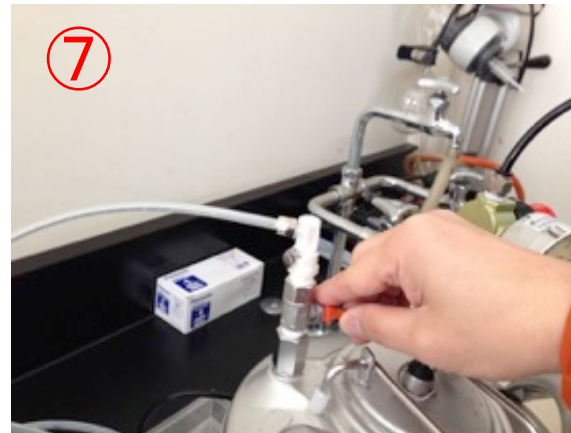
⑦加圧タンクの圧力を 少し高め試料を送る
