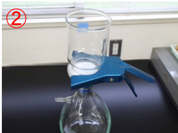
② フィルターを装着し固定する
