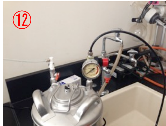
⑫ 圧力を下げ、すべてのバルブを閉じる
