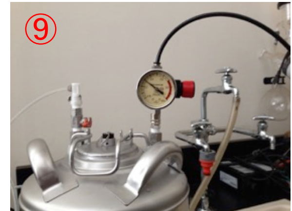
⑨ 設定圧力に調整する
