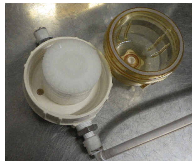
③ カートリッジフィルターをハウジングに装着し、通水を開始する。
