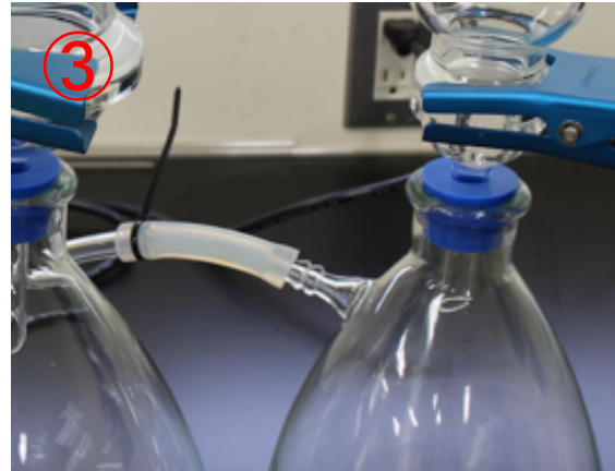
③ ろ過瓶と吸引ポンプをチューブで接続する
