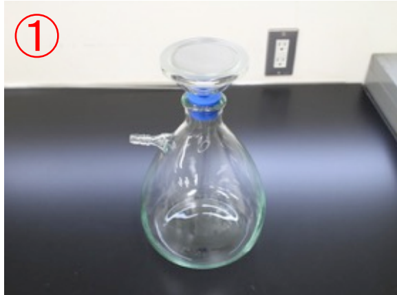
① ロートをろ過瓶に装着する
