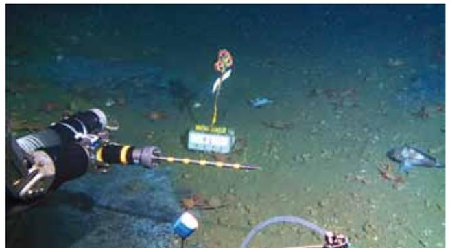
写真 2. ROV 潜航調査による海底地殻熱流量測定
