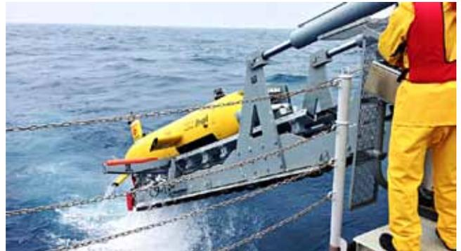
写真 1. AUV (自律式探査機) による海底音響探査
