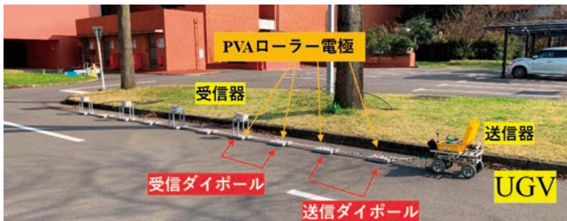
図 2 UGV 牽引型高周波交流電気探査装置：UGV (無人地上車両) により PVA (ポリビニルアルコール) ローラー電極および受信器を牽引し地下を非破壊で探査する。
