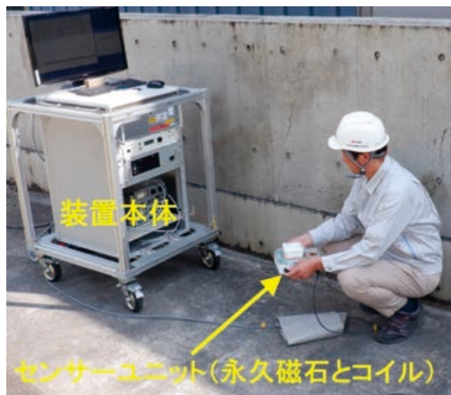
図3 開発した磁気共鳴表面スキャナーの屋外試運転風景。
