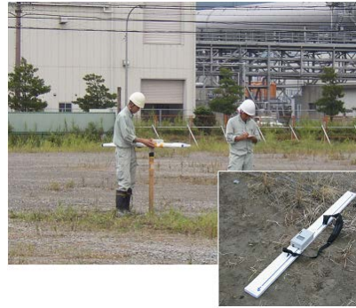
図 1 米国 Geopex 社製 GEM-2 電磁探査装置による電磁マッピング調査の様子.
