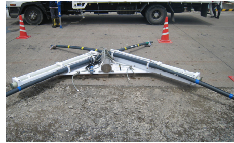
図 2：開発中の海底電磁探査装置の外観
