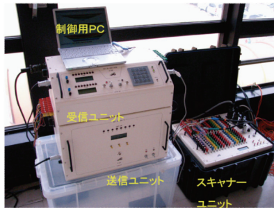
図 10：マルチ送信比抵抗探索装置の試作 2 号機。同時送信 8ch、受信 8ch で 64 個のデータを約 3 秒で取得でき、毎分 1200 点のデータを取得可能である。
