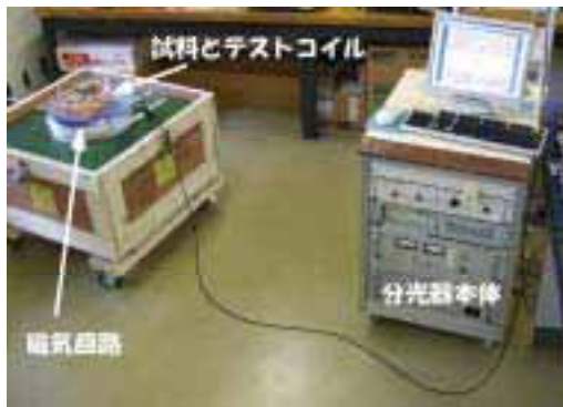
図 6: 開発中の NMR 計測システムによる模擬亀裂試料の計測実験。磁気回路表面から 5cm 上方の感度領域に水で満たされた模擬亀裂試料があり、その直下 1cm にテストコイルが配置されている。
