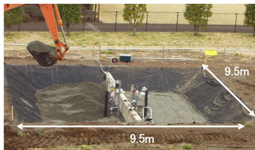
図 9: 人工地盤漏水実験サイト(奥村組技術研究所)。深さ 2.3m のピットの中央に孔の開いたモルタル壁を設け、ピット全体に川砂を埋めた。ピットの右側を飽和状態にして、モルタル壁を通しての水の移動を調べる。
