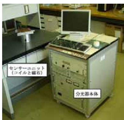
図 8: 現在開発中の NMR 物理探査装置。ワゴンに載った分光器本体(トランスミッターと制御用 PC を含む)と、永久磁石と rf コイルからなるセンサーユニットで構成されている。
