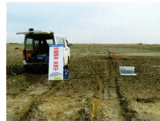
福島県の津波被災地における電気探査
