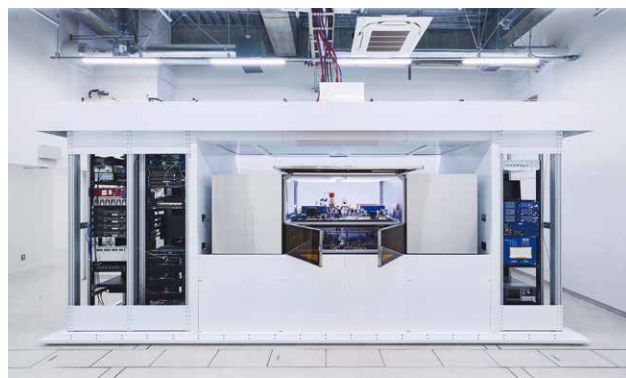
中性原子量子コンピューター(システムQ) Neutral atom quantum computer (System Q)
