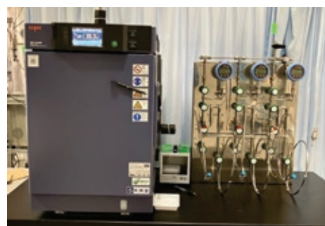
構築した水素シール材の評価設備 左：環境試験器 右：配管ユニット
