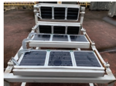
図6 藤倉コンポジットにおける屋外暴露試験の様子
