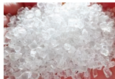
解体後のガラス
