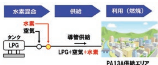
相馬ガス株式会社での水素混合LPガス供給の模式図
