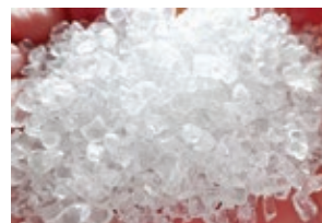
解体後のガラス
