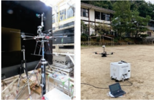
風況調査用ドローンの風洞実験及びフィールド試験による実証
