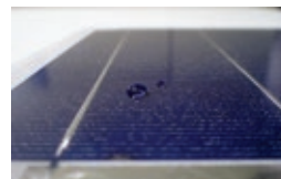
図2 表面処理を行った太陽電池モジュールの水滴の様子
