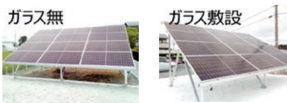
図 システムレベルのガラス敷設有無の実証外観
