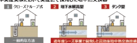
本実証実験において実証区で採用した地中熱交換器
